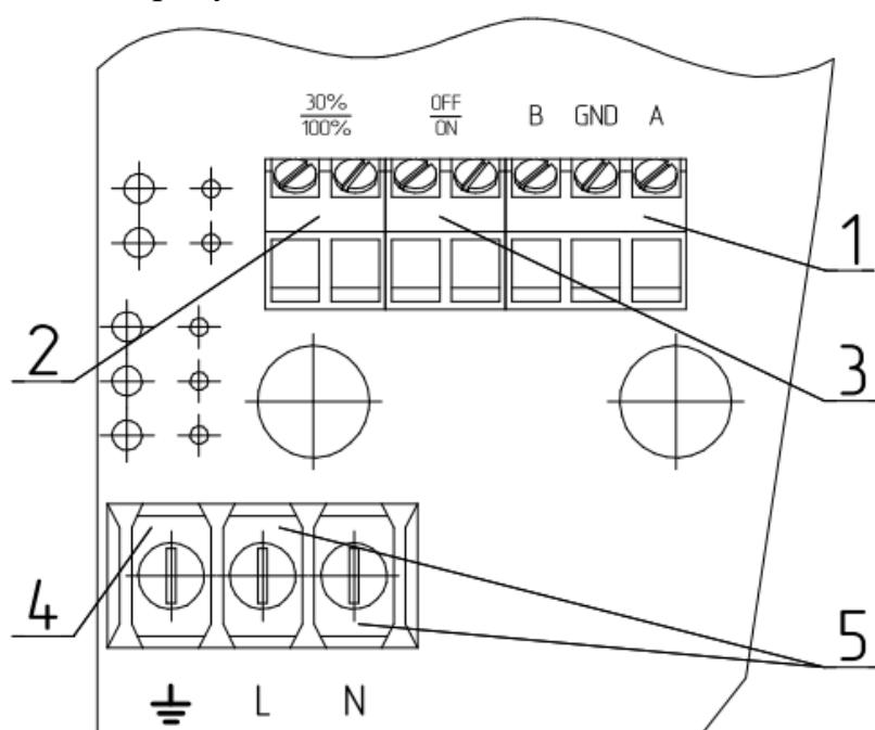
1 - клеммы подключения кабеля интерфейса RS-485;
